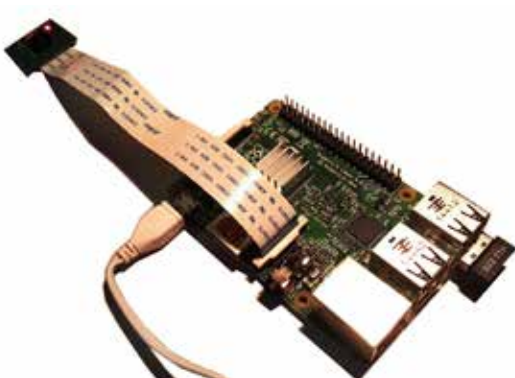
Figura 4. Il Raspberry PI completo del dongle e della web camera
